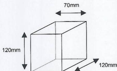
Que la caja está destinado a contener 28 sobres de jugo Yupi, de 45 gramos cada uno. "Display" o exhibidor que se presenta plegado, ensamblado mediante pegamento, solamente por una de las caras laterales y un par de aletas de la base de dicha caja. Presenta, además, un prepicado de diente ancho, para dar forma a las aristas basales, laterales y superior anterior y posterior, también se encuentran plizadas para favorecer el armado final.
