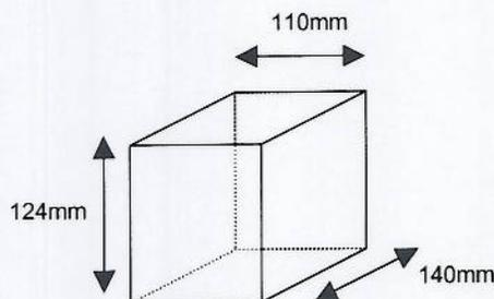
Que la caja está destinado a contener 20 sobres de jugo Hikory, de 45 gramos cada uno. "Display" o exhibidor que se presenta plegado, ensamblado mediante pegamento, solamente por una de las caras laterales y un par de aletas de la base de dicha caja. Presenta, además, un prepicado de diente ancho, para dar forma a las aristas basales, laterales y superior anterior y posterior, también se encuentran plizadas para favorecer el armado final.
