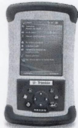
Que, el producto tiene dos ranuras para compactflash (CF), que le permiten agregar tarjetas GPS, escáners para código de barras, y otros dispositivos. También puede utilizar las ranuras para agregar tarjetas Bluetooth y LAN integrado.
